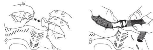
1 Pour fermer correctement la boucle, insérer les "pattes mâles" dans le "longement femelle" jusqu'à ce qu'un déclic audible se produise. Régler la sangle de façon à ce qu'elle soit bien ajustée sous le menton. 2 Pour ouvrir la boucle, pincer les bords droit et gauche des pattes mâles qui seront alors automatiquement éjectées du logement femelle.
